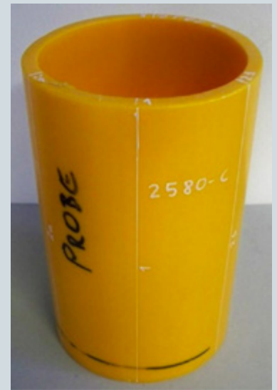
Bild 5: Prüfmuster Gas [6] aus HDPE XSC Orange
