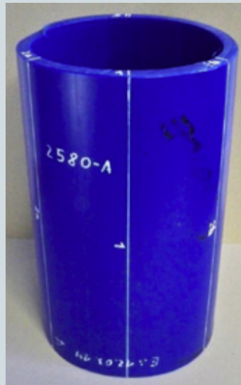
Bild 4: Prüfmuster Trinkwasser [5] aus HDPE XSC Blue
